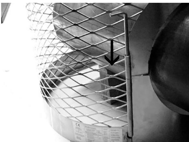
5. Закрепите пластины на кожухе с помощью двух штифтов
