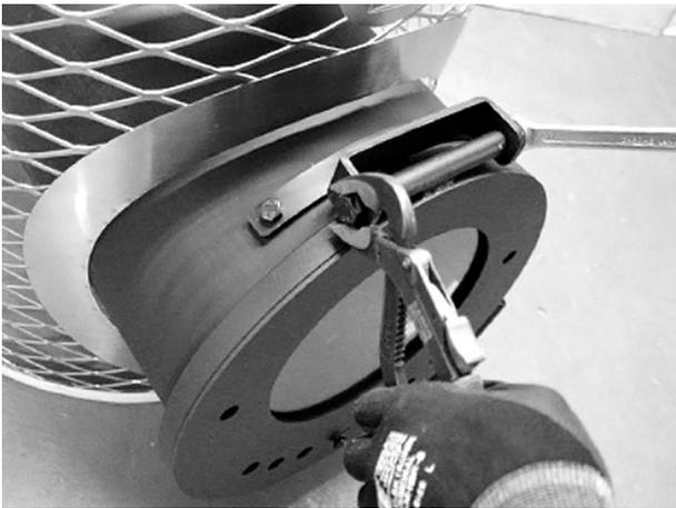
7. Установите дверцу с помощью ключа 17 мм.
